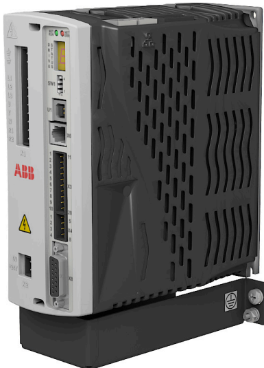
Assembled MicroFlex e150 and fan tray
